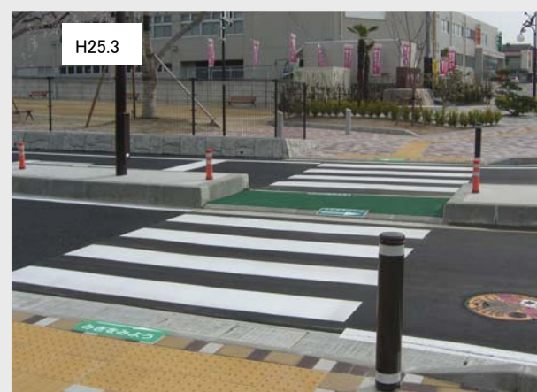
← 交通島の設置により歩行者は2段階横断が可能。さらに流出入車の交錯を防ぐ役割もある。
